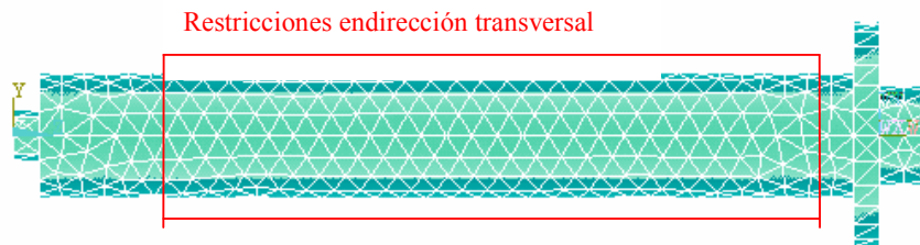
Figura 6 – Malla para el análisis del yunque por el MEF
